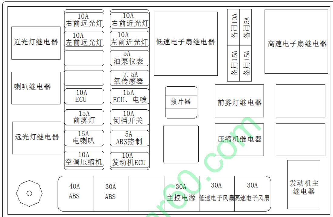
发动机舱配电盒（配 4G18S1 发动机、博世 ABS）：
